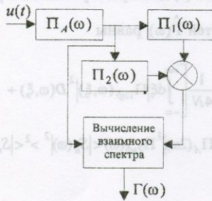
Рис. 1. Блок-схема алгоритма вычисления \Gamma(\omega) : \Pi_A(\omega) , \Pi_1(\omega) и \Pi_2(\omega) – передаточные характеристики входного устройства анализатора и фильтров
