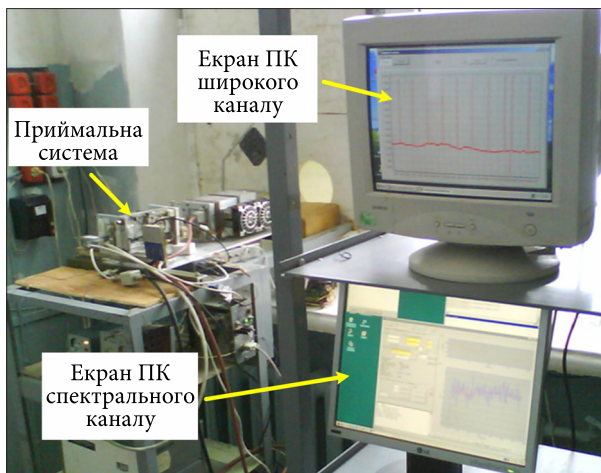
Рис. 1. Зовнішній вигляд спектродіаметричного комплексу РІ НАНУ для моніторингу малих атмосферних домішок (СО та O 3 )
