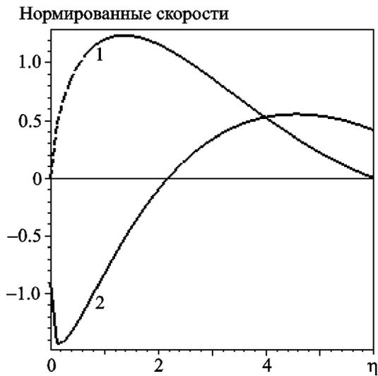
Рис. 16. Нормированные скорости движения в ядре: кривая 1 – радиальная, кривая 2 – осевая
