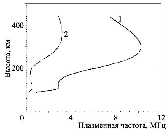
Рис. 2. Модельные вертикальные профили плазменной частоты электронов при высокой солнечной активности (г. Харьков): 1 – зима, день; 2 – зима, ночь. Эффективное число солнечных пятен равно 100
