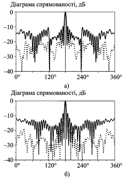
Рис. 7. Нормовані діаграми спрямованості модельної ДЛА, параметри якої відповідають вказаним на рис. 4, в та рис. 4, г відповідно: — — ізотропне джерело, - - - — оптимально спрямоване джерело
