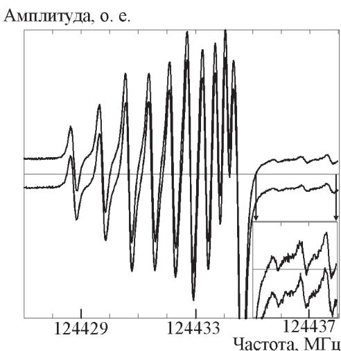
**Рис. 5.** Записи участка спектра молекулы  $CF_3CH_3$  на частотах около 124 ГГц, полученные при использовании нового опорного синтезатора частоты на основе DDS (верхняя запись) и со старым опорным синтезатором (нижняя запись). Для наглядности записи разнесены по вертикали. Для оценки шумов в нижней части рисунка приведены фрагменты записей, увеличенные в 6 раз по амплитуде
