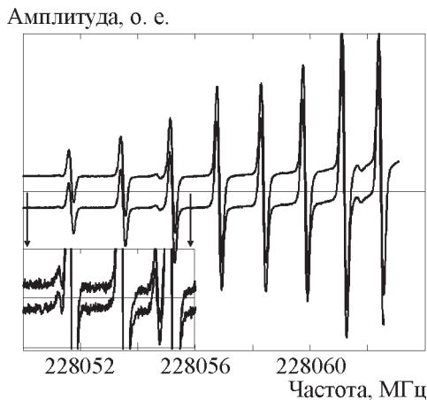
**Рис. 6.** Записи участка спектра молекулы  $CF_3CH_3$  на частотах около 228 ГГц, полученные при использовании нового опорного синтезатора частоты на основе DDS (верхняя запись) и со старым опорным синтезатором (нижняя запись). Для наглядности записи разнесены по вертикали. Для оценки шумов в нижней части рисунка приведен фрагмент, увеличенный в 15 раз по амплитуде
