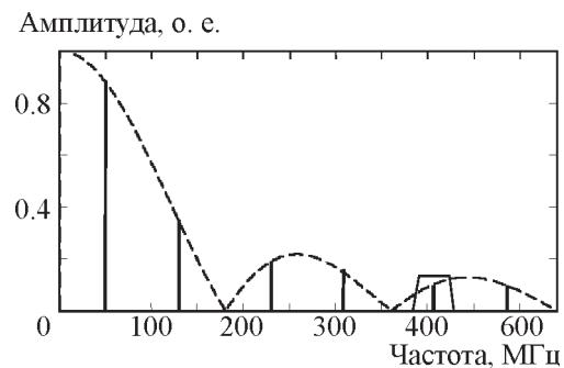
**Рис. 2.** Спектр генерации идеального синтезатора прямого цифрового синтеза при частоте выходного сигнала  $50$  МГц (тактовая частота равна  $180$  МГц)
