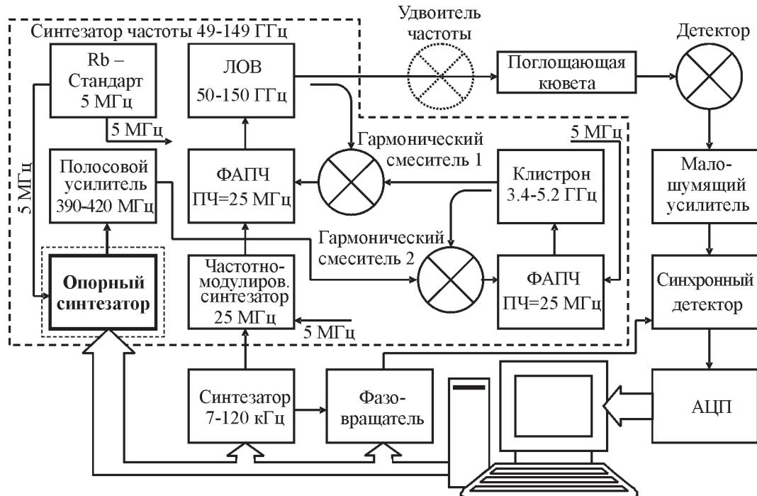
Рис. 4. Функциональная схема спектрометра миллиметрового диапазона
