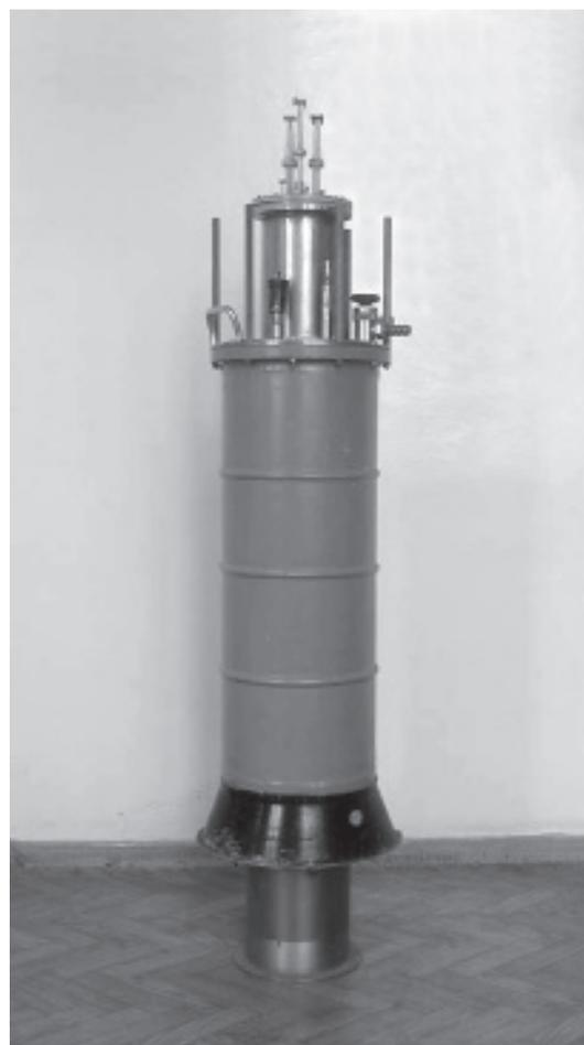
**Рис. 2.** Квантовый усилитель 3-мм диапазона на андалузите
