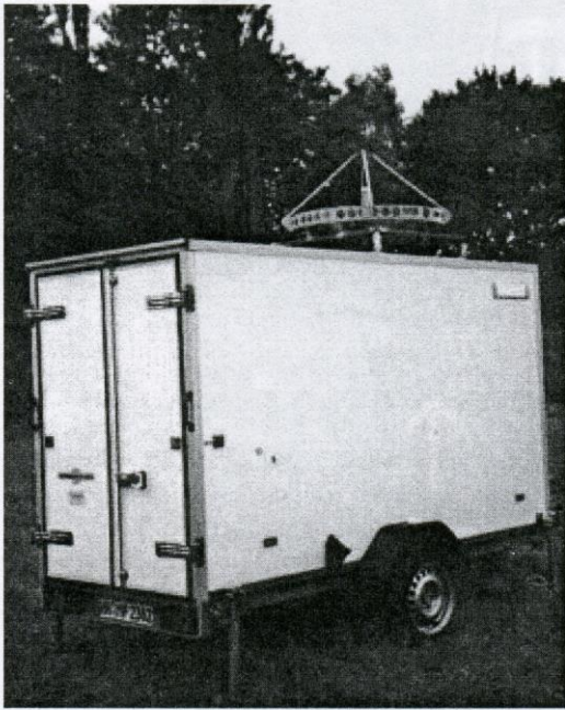
Доплеровский метеорологический локатор 8-мм диапазона. Разработка РИ. Фотография любезно предоставлена Д. М. Вавривым (РИ)
