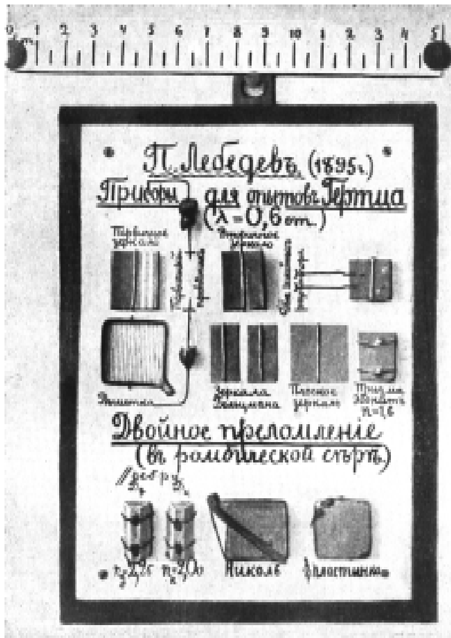
Рис. 4. Комплект устройств, разработанных Лебедевым для осуществления опытов Герца на волне \lambda = 6 мм. (Репродукция из работы [26])
