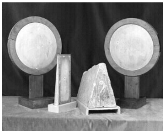
Рис. 7. Линзы, используемые в экспериментах Риги. (Репродукция со страницы http://www.df.umbo.it/museo/files/RIGHI.HTM с любезного разрешения Museo di Fisica, Dipartimento di Fisica, Universita degli Studi di Bologna (Italy))
