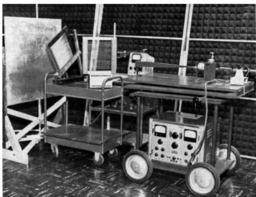
Рис. 14. Антенный переключатель открытого типа для работы в режиме круговой поляризации ( \lambda = 5 мм). (Репродукция из работы [48])
