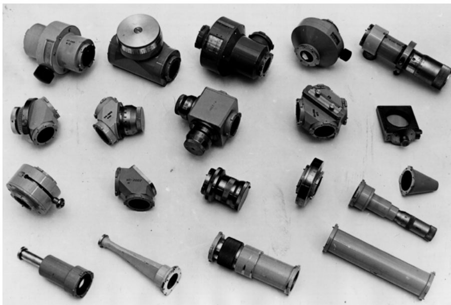
Рис. 26. Комплект квазиоптических измерительных устройств на основе полого диэлектрического лучевода. (Фотография любезно предоставлена В. К. Киселевым)
